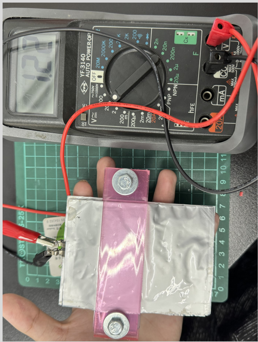
三用電表測量第一代模組圖 (由作者群拍攝)
