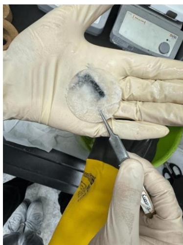
圖 4-21 隔離膜與碳只有空隙的鋁包，剪開後隔離膜只有與 Ni-bar 接觸的地方有漿料。(由作者群拍攝)
