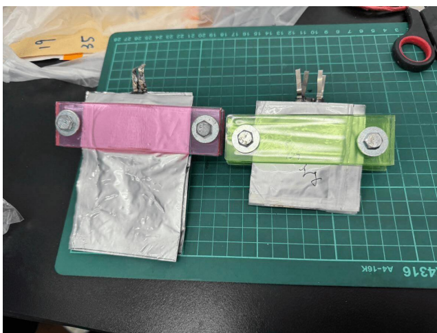
圖 4-30 左邊為第一代充電模組，右邊為第二代充電模組，兩者在體積上有明顯差異。(由作者群拍攝)
