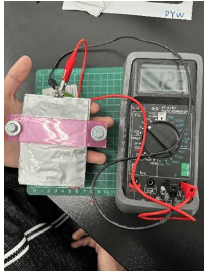
圖 4-27 充電模組放置一個月之後並進行正常充放電，電壓約穩定維持 1.2V 左右。(由作者群拍攝)
