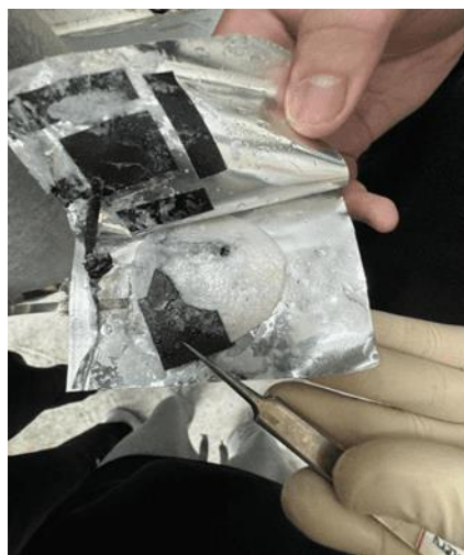
圖 4-24 剪開電池取出隔離膜，可以觀察到是否反應成功。(由作者群拍攝)
