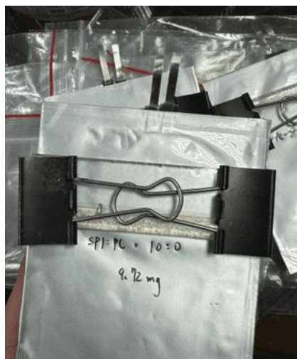
圖 4-23 我們用塑膠板加長尾夾緊緊夾住碳紙與隔離膜的位置。(由作者群拍攝)
