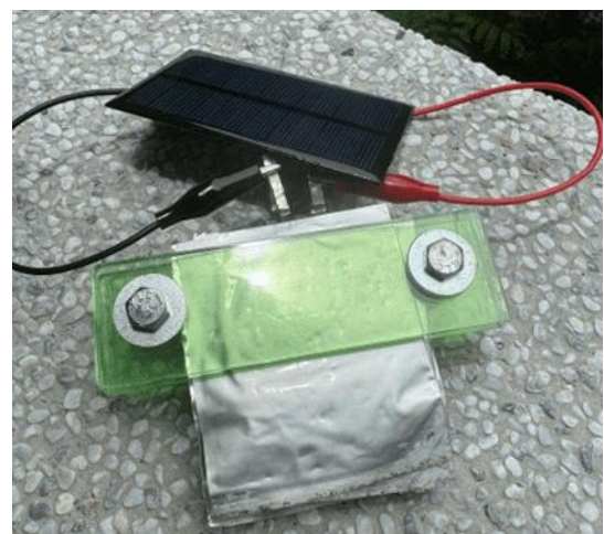
圖 4-31 第二代充電模組加上太陽能板進行充電的過程。(由作者群拍攝)
